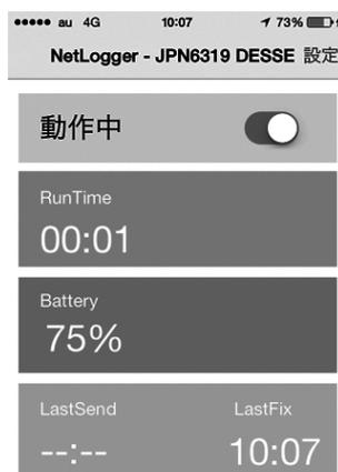
ホームボタンでメイン画面に移動します。「動作中」の表示と現在時刻とLASTFixが同じ時刻であれば送受信は正常に稼働しています。
